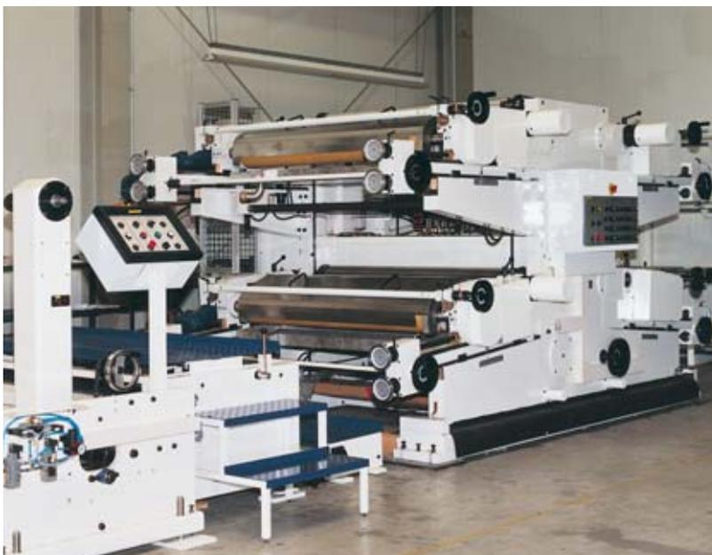
Diese In-Line-Vorsatzdruckmaschine mit bis zu vier Farbwerken garantiert eine hervorragende Druckqualität. Hydraulische Farbwerksklemmung, unbegrenzte Längsregister-einstellung, elektronische Druckzylinder Einstellung sowie eine automatische Abhebung der Farbwerke mit Farbwalzenweiterlauf bei Stillstand der Maschine sorgen für hohen Bedienkomfort.
