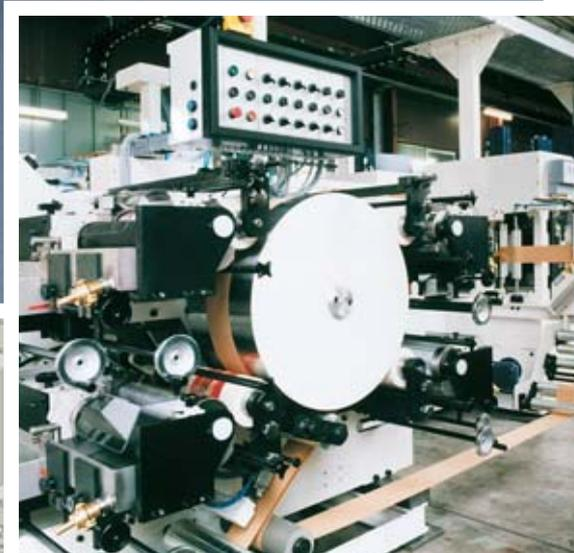
Zentralzylinder-Druckmaschine für Bodendeckblatt
