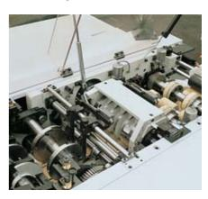
Feinjustage bei laufender Maschine über Servomotoren (Opt.) vom Bedienpult aus. Verstellung der Greifer in Aufziehstation zentral oder individuell. Messereinstich im 2. Vorbruch erleichtern das Aufziehen.
