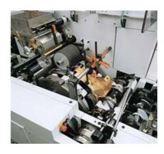
Der erste und zweite Finger der Bodenfalztrommel werden per Servomotor (Option) zentral oder individuell für jede Seite – auch bei laufender Maschine verstellt. Ein Zahnsegment justiert alle Bodenstationen gleichzeitig.
