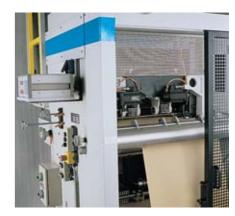
Zur Einführung gehört eine servogetriebene (Option) Stanze für unterschiedliche Schnittwerkzeuge (Staubsaugerbeutel).
