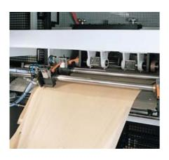
Die Zustellung der servo-angetriebenen (Option) Stanzwerkzeuge erfolgt manuell.
