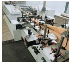
Bei der Schlauchbildung wird die Faltentiefe über Servomotoren (Option) eingestellt. Eventuelle Korrekturen erfolgen bei laufender Maschine vom Bedienpult aus. Alle Einstellungen sind reproduzierbar.
