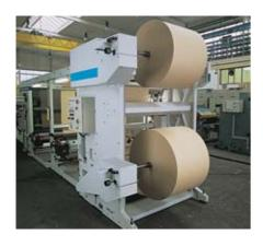
Zur Bahnspannungsregulierung besitzt die Abwicklung eine feinfühlige Tänzerwalze.
