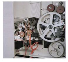
Die Abschnitteinrichtung erledigt Glatt- oder Zackenschnitt mit einem leicht einstellbaren, umlaufenden Obermesser mit Servomotor.
