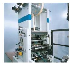
Unterschiedliche Bodendeckblatt-Stationen können bis zu vollflächig verkleben. Die Station ist ebenfalls servogetrieben (Option) und mit Flexodruckwerk oder Registersteuerung lieferbar.
