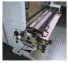
Servomotoren (Option) treiben die Fütterung an. Weiterlauf mit Schnellabstellung der Leimeinrichtung.
